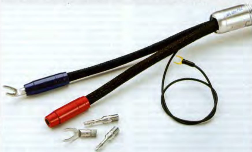
Il dettaglio è sulle terminazioni Berri Bus: un sistema di crimpaggio sul cavo che permette l'intercambiabilità tra forcelle e banane che hanno l'attacco filettato. Il filo aggiuntivo che si vede ha una funzione molto specialistica e può essere utilizzato per trasportare il feedback dai diffusori all'amplificatore.
